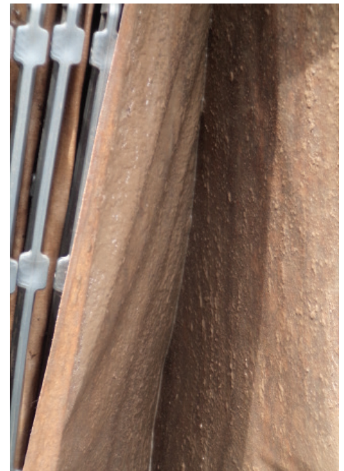
Biomassa suspensa e suportada verticalmente, cercada de oxigênio - uma característica da tecnologia BioGill.
