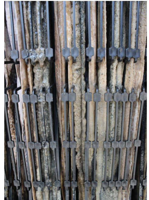
Biomassa em suspensão verticalmente suportada e cercada de oxigênio - uma característica chave da tecnologia BioGill.
