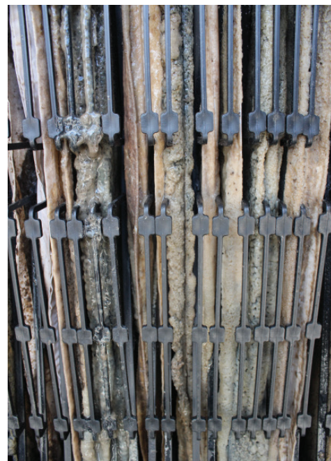
Biomassa em suspensão verticalmente suportada e cercada de oxigênio - uma característica chave da tecnologia BioGill.
